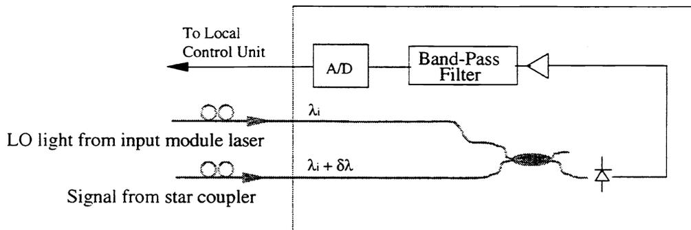
Fig. 4. Carrier Detector
